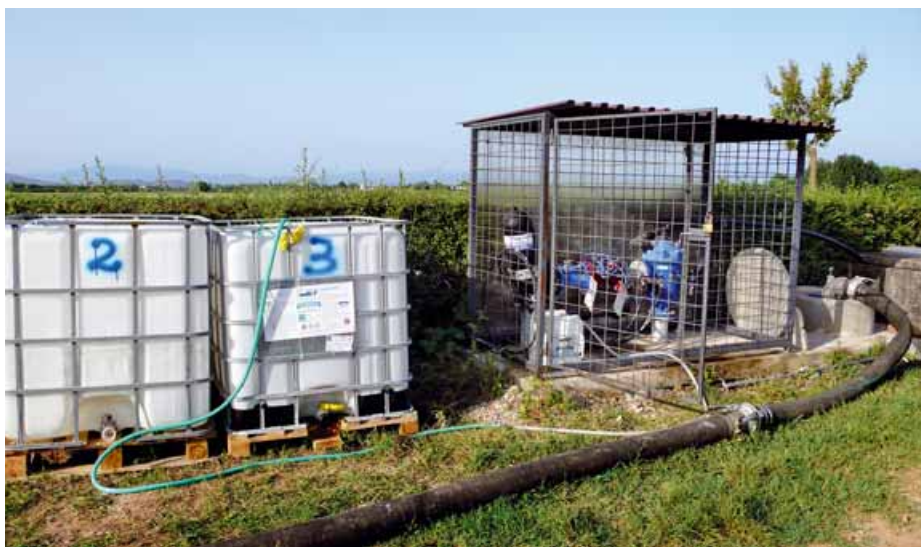
Ottenere un profilo organolettico con un'acidità più spiccata, per un vino più fresco e di lunga durata agendo sulla concimazione: questo l'obiettivo della prova che è stato conseguito nelle due tesi fertirrigate. Nella foto la stazione di filtraggio dell'acqua e iniezione (Venturi) della soluzione concentrata
